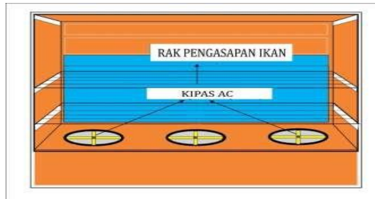
Gamabr 3.4 Letak Kipas Dan Rak Pengasapan
